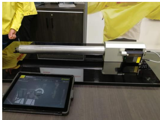
工作機械用ドリルセンサー データウェイ上で推論を実行、リアルタイムに数値判定 (熱・振動・取付軸角度)
